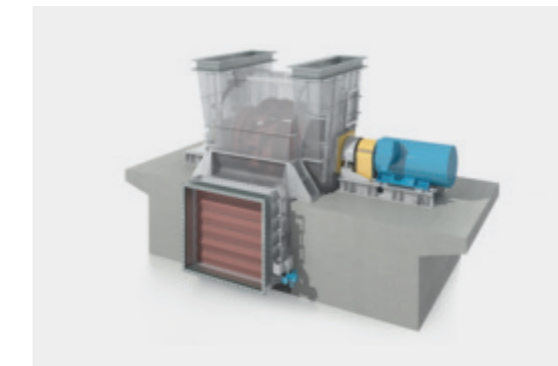
KBZ Antrieb über Kupplung, auf Betonfundament, Laufrad beidseitig gelagert, zweiseitig saugend.
